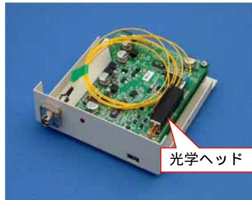
図5 SOP モニタモジュール 図4の光学ヘッドと計算用電気回路を 組み合わせたもの
