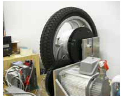
(a) ブレーキと固定子 (b) ホイール型回転子(40極) (c) 組立後のDDモータ
