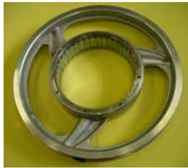
(a) ブレーキと固定子 (b) ホイール型回転子(40極) (c) 組立後のDDモータ
