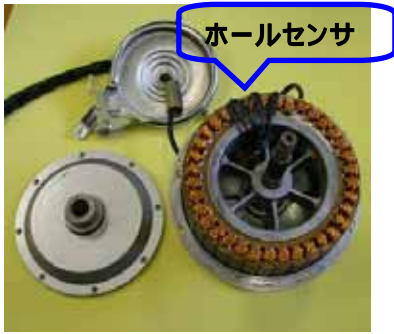
(a) ブレーキと固定子 (b) ホイール型回転子(40極) (c) 組立後のDDモータ
